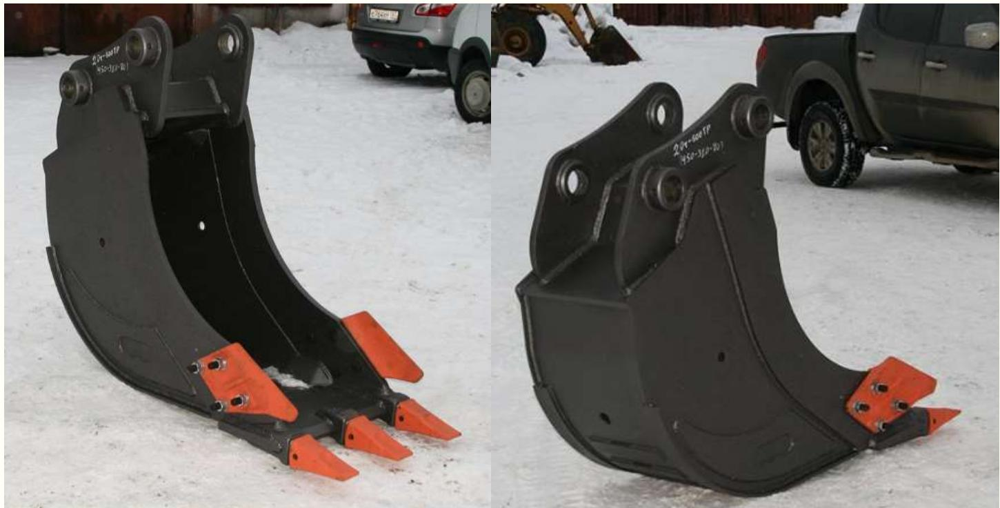
Траншейные ковши предназначены для большинства общеземляных работ. Идеальны для работ с глиной, песком, гравием и пр. Благодаря усиленному исполнению ковш может быть использован и для работ с мерзлым грунтом. Все ковши выполнены из износостойкой стали и, по желанию клиента могут быть усилены элементами из шведской износостойкой стали **Hardox**.
