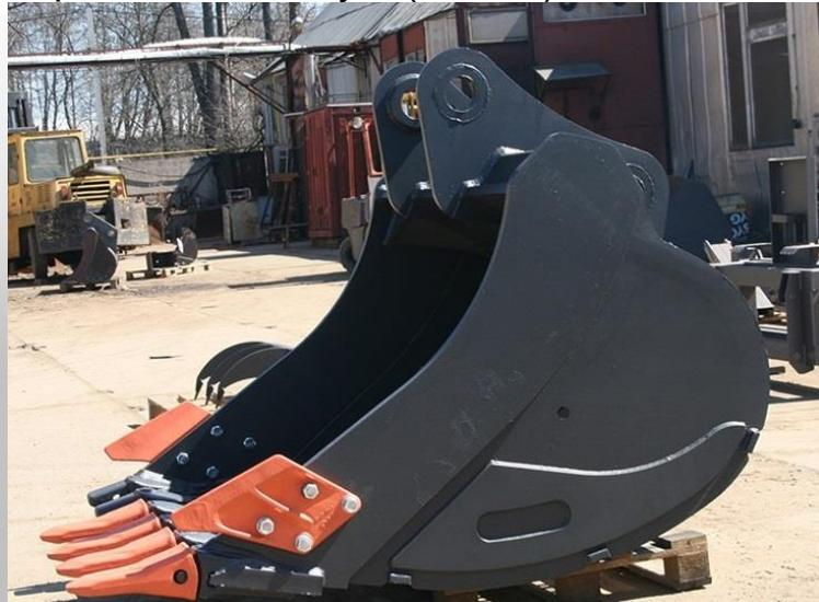
Универсальный усиленный ковш предназначен для большинства общеземляных работ. Идеальны для работ с глиной, песком, гравием и пр. Благодаря усиленному исполнению ковш может быть использован и для работ с мерзлым грунтом. Все ковши выполнены из износостойкой стали и, по желанию клиента могут быть усилены элементами из шведской износостойкой стали **Hardox**.
